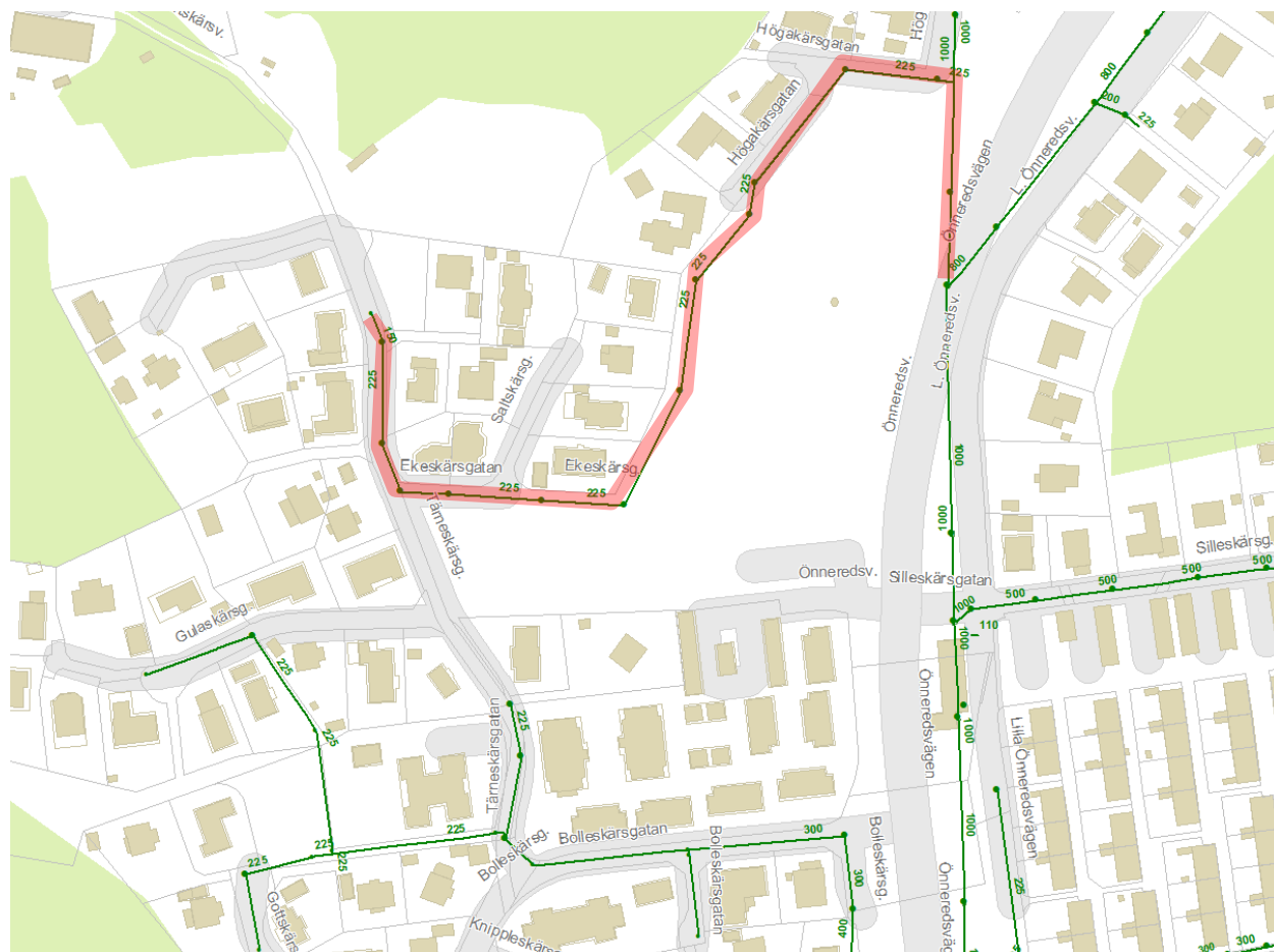
Figur 10. Ledningskarta över norra delen av planområdet. Dagvattenledningar och ledningsdimensioner redovisas. Ledningar markerade med röd linje har översvämningsrisk vid dimensionerande regn. (Källa: Solen).
